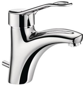
Cartouche céramique Ø 40. Butée de température maximale pré-réglée. Débit limité à 5 l/min à 3 bar. Fixation renforcée. Manette ajourée. Livré avec flexibles PEX F3/8". Hauteur 165 mm
