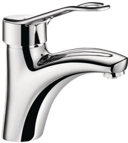
Mitigeur mécanique de lavabo H.85 L.135 avec sortie BIOSAFE hygiénique. Cartouche céramique Ø 40. Butée de température maximale préréglée. Débit limité à 5 l/min à 3 bar. Commande par manette ajourée. Sans tirette ni vidage. Flexibles PEX F3/8". Fixation renforcée par 2 tiges Inox.
