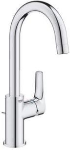
Monotrou sur plage, Bec tube pivotant. Tirette et garniture de vidage 1-1/4". Flexibles de raccordement souples. Levier de commande métallique. GROHE SilkMove Cartouche en céramique 28 mm avec limiteur de température. GROHE StarLight Chrome éclatant et durable. GROHE EcoJoy mousseur 5 l/min. GROHE FastFixation installation rapide.
