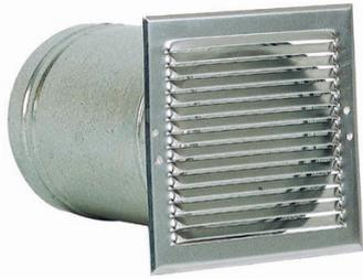
Cette grille munie d'un manchon télescopique vous permettra de réaliser une entrée d'air ou un rejet d'air jusqu'à 200 m<sup>3</sup>/h dans un mur.
