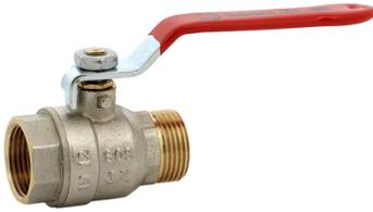
Passage intégral. Presse étoupe en PTFE (120°C). Laiton titré conforme Norme Européenne EN12165. Manette plate. Traçabilité (logo-date de fabrication). ACS et conforme 4MS.
