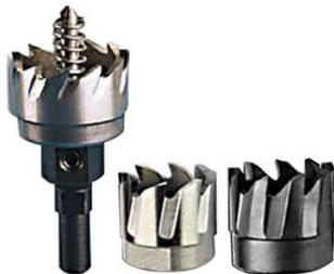
Trépan complet HSS GP / TOP Fraise à trépanner recommandée pour matériaux ferreux tel inox, fer, aluminium, fonte jusqu'au 7 mm d'épaisseur. Avec queue et foret équipés d'un ressort pour évacuation de la rondelle coupée.
