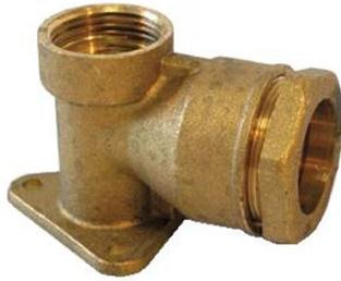
Dimensions : DN20 à DN90 Raccordement : Femelle, Femelle BSP et sur tube polyéthylène Température Mini : +4°C Température Maxi : +40°C Pression Maxi : 16 Bars jusqu'au DN63 (10 bars au-delà) Caractéristiques : Raccords laiton pour tube Polyéthylène Joint torique NBR Montage sur tube sans démontage du raccord
