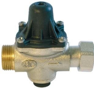
Le réducteur de pression SECURO possède un raccordement en entrée mâle et sortie avec écrou tournant. Testé en réglage 1 à 5,5 bar, le réducteur est pré-réglé à 3 bar. Les fluides admis sont l'eau, l'air et les gaz neutres. Conforme aux normes ACS. Pression : 16 bar. Diamètre nominal : 20 mm.
