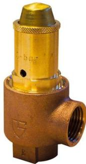
Sans manomètre. Corps bronze. Tarage : 3 bar. Diamètre raccordement/échappement : 1/2" F - 1/2" F. Plage de température : -10/+120°C. Capacité d'évacuation : 173 kW. Glycol maxi : 50 %.
