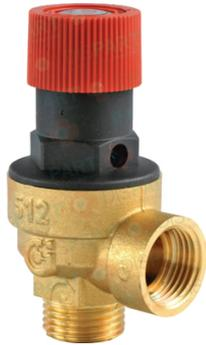
Corps laiton matricé. Joint & membrane EPDM. Ressort inox UNI 3823. Manette ABS. Pression nominale PN10. Températures 5 / 110°C.
