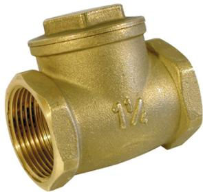
Clapet de non-retour simple battant laiton 4MS étanchéité métal/métal pour les réseaux d'adduction, de distribution et d'évacuation d'eau. Montage horizontal ou vertical avec fluide ascendant.
