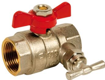
Passage intégral. Presse étoupe en PTFE (120°C). Laiton titré conforme Norme Européenne EN12165. Manette papillon. Traçabilité (logo-date de fabrication). ACS et conforme 4MS.
