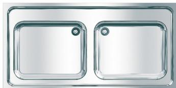
Plonge professionnelle en inox 18/10 soudé avec le piètement. 2 bacs vidage 1-1/2 avec tube de surverse combiné inox et plastique, épaisseur matériau 1 mm, surface satiné. Remontée arrière 100 mm. Tous les modèles sont pourvus d'une plage de robinetterie de 80 mm. Carénage sur les trois côtés de 300 mm, pieds 40x40 mm nivellables en hauteur à 25 mm.
