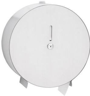
Distributeur de rouleau Jumbo mural. En inox, surface satinée. Epaisseur du matériau de 0,8 mm. Serrure à barillet avec clé standard Franke. Boîtier arrondi fermé avec fenêtre de contrôle. Retrait du papier entre deux bords dentelés. Pour un rouleau d'un diamètre maximal de 260 mm. Fixations incluses.
