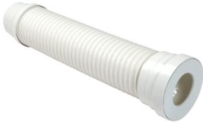
Embout droit PVC. Joint élastomère. Surface intérieure lisse. Départ étagé Ø 93 et Ø100 mm à coller.
