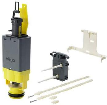
Pour réservoir de chasse d'eau à encastrer 1H, réservoir de chasse d'eau à encastrer 2H, modification ultérieure sur plaque de commande Visign for Style ou Visign for More. Plastique. Déclenchement de la chasse d'eau par l'avant, technique de chasse d'eau à 2 volumes.
