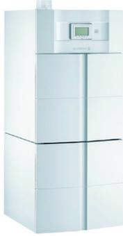
Chaudières gaz au sol, à condensation pour chauffage et eau chaude sanitaire. Préparateur ecs émaillé à serpentin "Standard Load". Préparateur placé sous la chaudière pour constituer une "colonne" d'une esthétique uniforme. Protection par anode en magnésium. Tubulures de liaison chaudière/ballon et sonde ecs incluses, pieds réglables.
