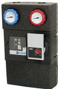
Conçus pour les applications nécessitant un transport de l'énergie des plus efficaces. Équipé de deux vannes d'arrêt avec thermomètres, d'un clapet anti-retour, d'une coque d'isolation de qualité supérieure et d'un circulateur à rendement élevé. Groupe équipé d'une pompe. De taille DN25 avec une pompe Wilo PARA 25/6. La pompe peut être paramétrée avec une vitesse constante, une pression variable ou une pression constante.
