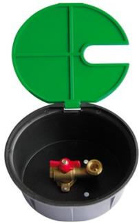
Bouche d'arrosage polypropylène Série 695 avec vanne à sphère sortie d'équerre laiton 4MS pour des réseaux d'arrosage. Couvercle fermable avec tuyau branché. Vanne équerre avec presse étoupe PTFE.
