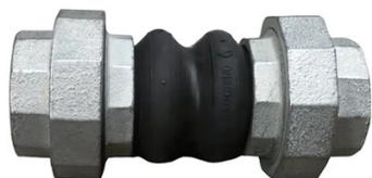
Compensateur de dilatation élastomère, avec soufflet EPDM, raccords union. Fonte galvanisée, renfort toile Nylon, PN16 pour réseaux d'adduction et de distribution d'eau.
