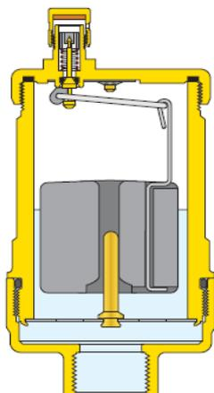
L'accumulation des bulles d'air dans le corps du purgeur fait descendre le flotteur et par conséquent, ouvrir l'obturateur.
