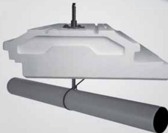
**Nicoll** innove avec son nouveau système de suspenste de canalisation pour hourdis (polystyrène, bois...) **FIXOTUBE**. Ce nouveau dispositif permet la fixation solide et durable des tubes d'évacuation dans le vide sanitaire et assure avec son système de réglage une gestion optimisée de votre pente de canalisation.
