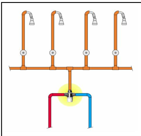
Le mitigeur protège une "zone" d'utilisateurs, selon la réglementation ce type d'utilisation ne peut être mis en place que si le volume d'eau mitigée est inférieur à 3 litres.
