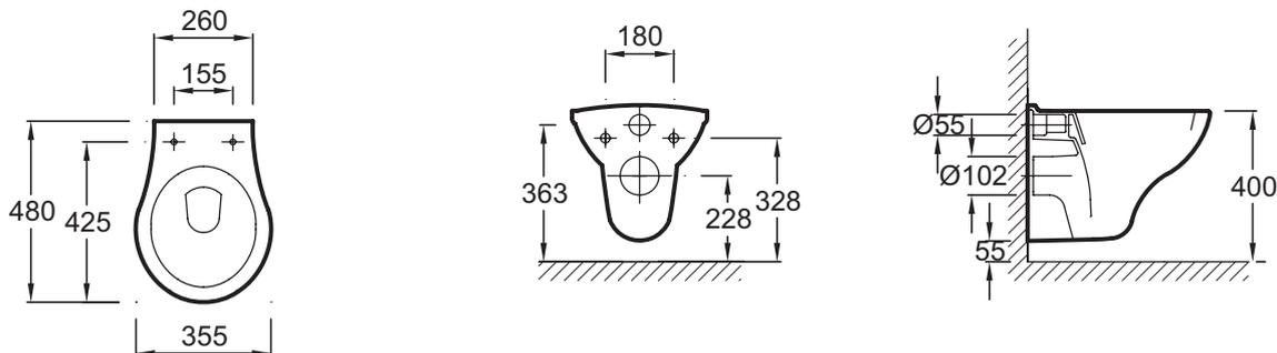
Descriptif CCTP : Cuvette suspendue compacte. E1534. Collection : PATIO. DIMENSIONS : 48 x 36,50 cm. POIDS : 12,8 kg. MATÉRIAU : Céramique. TYPE D'INSTALLATION : Suspendu. CONSOMMATION D'EAU : Standard 3/6 L. HAUTEUR : Réglable de 38 à 50 cm. TYPE DE BRIDE : Ouverte (traditionnelle). GARDE D'EAU : Réglable de 38 à 50 cm. PRODUIT INCLUS : (abattant non inclus). Existe aussi en version sans trou d'abattant E1534-Y1.
