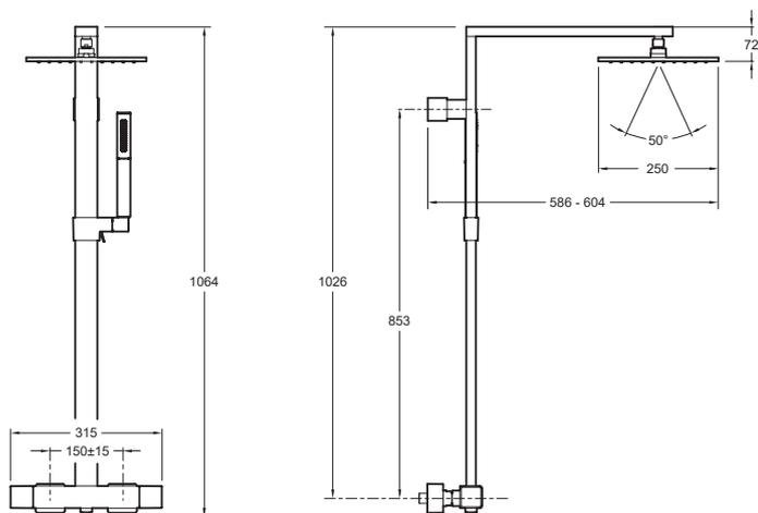
Description : Colonne de douche avec mitigeur thermostatique et douche de tête carrée.. E98321. Collection : STRAYT. Dimensions : 25 x 25 cm. Poids : 10,4 kg. Installation : Mural. Douchette à main Shift Square 2 jets.. Fonctionne avec tous types de chauffe-eau d'une puissance minimale de 18 kW..
